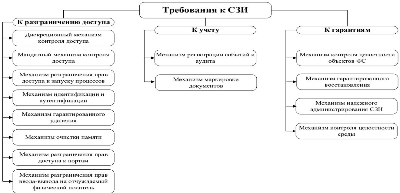
Рисунок 1 – Механизмы защиты, обеспечивающие выполнение требований к СЗИ
